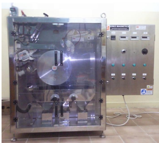
Slika 2. Elektrostatički separator "ERIEZ" model ESP-14/01S
