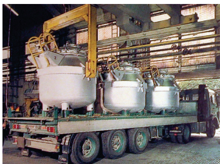
Slika 5. Termolonci za prenos tečnog metala
