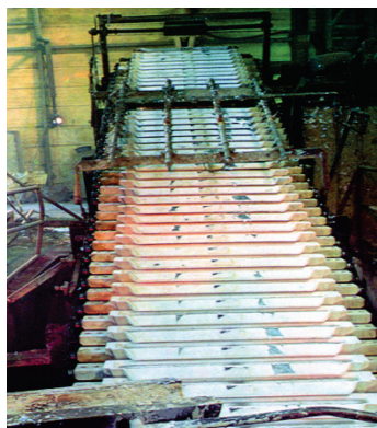
Slika 7. Livenje sekundarnih legura aluminijuma u ingote
