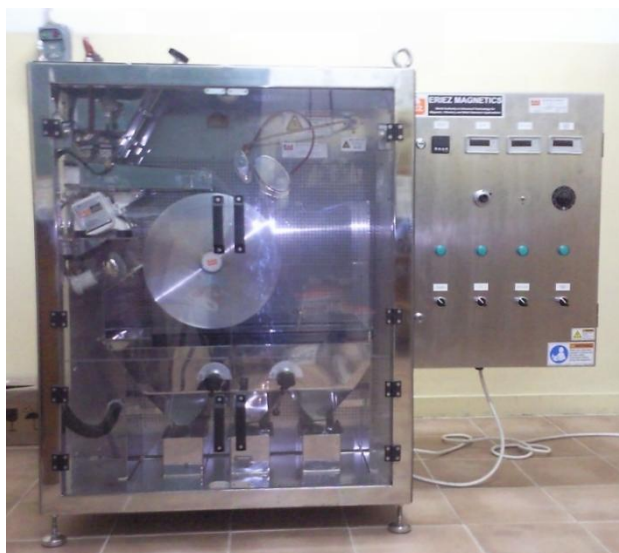
Slika 2. Elektrostatički separator "ERIEZ" model ESP-14/01S
