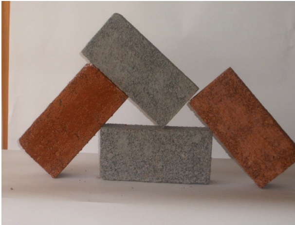
Fotografija 3. Izgled šljakobetonskih blokova, dobijenih od šljake fabričke energane, sa ili bez dodatka crvenog mulja kao pigmenta.
