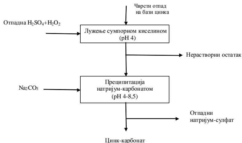
Слика 1. Приказ процеса лужења чврстог отпада на бази цинка отпадном акумулаторском сумпорном киселином и добијање цинк-карбоната
